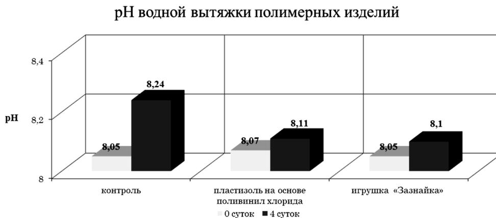
Рис 2. pH вытяжки полимерных изделий.
