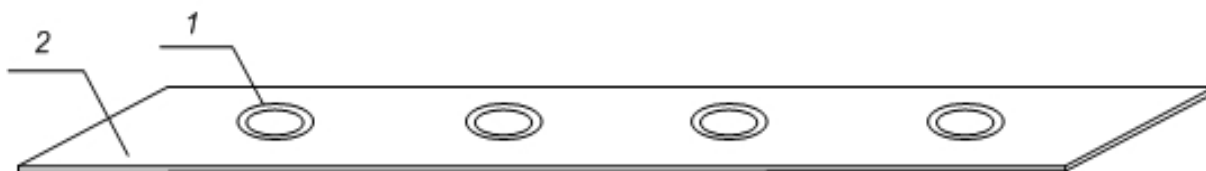
Рис. 1. Волновод с источником механических колебаний: 1 - Пьезоизлучатель или источник механических колебаний; 2- Волновод из упругой металлической нержавеющей пластины.
