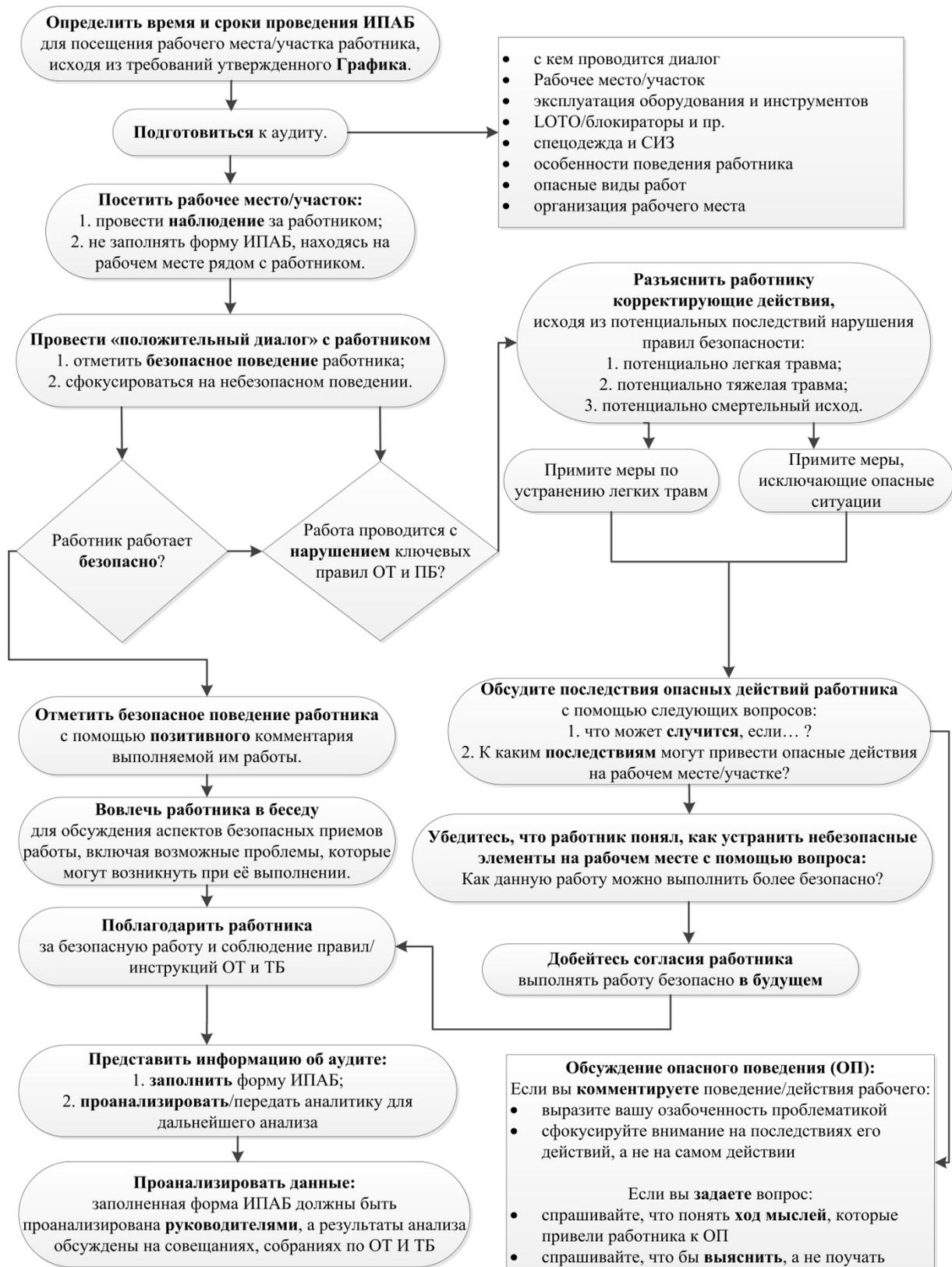
Рис. 1. Структурно-логическая схема последовательности проведения процедуры ИПАБ.
