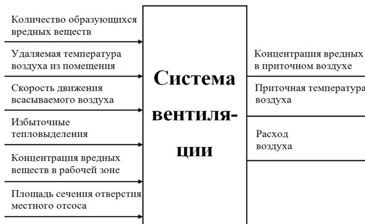
Рис. 1. Структурная модель работы системы вентиляции в виде «черного ящика».
