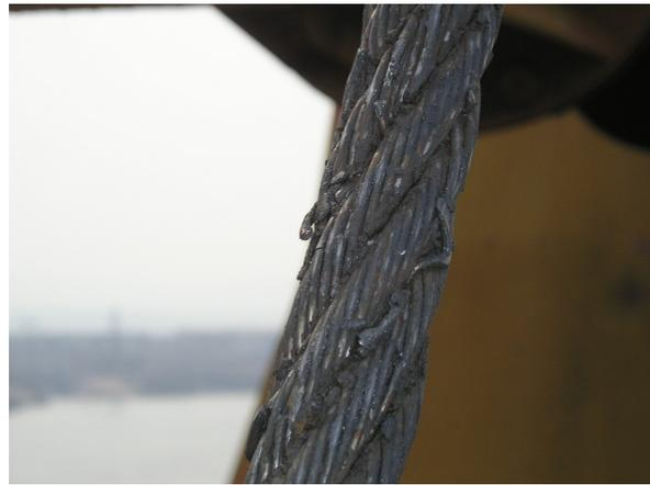
**Рис. 18.** Множественные обрывы проволок грузового каната портального крана.
