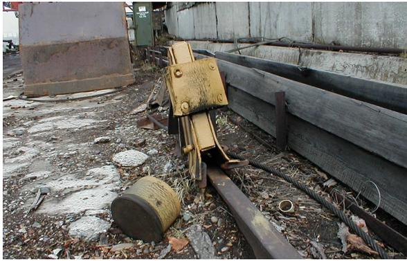
**Рис. 15.** Разрушение тупикового упора крана портального КПП-16(20)-30.
