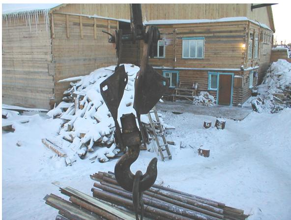
**Рис. 16.** Самодельная крюковая подвеска крановой установки автомобильного крана (железнодорожный тупик).
