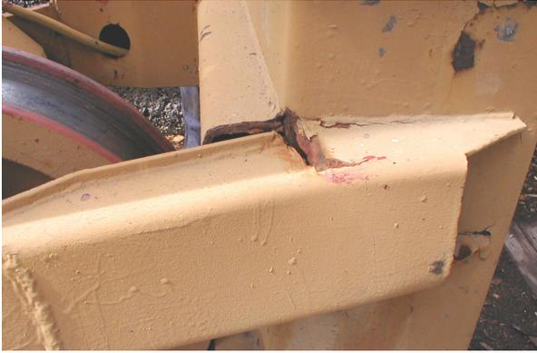
**Рис. 3.** Трещины и разрывы по основному металлу в местах крепления противоугольного устройства портального крана КПП-16(20)-30.
