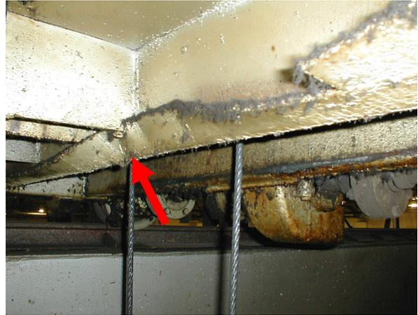
**Рис. 6.** Деформация поперечной балки рамы грузовой тележки мостового крана от переподъема крюковой подвески в результате несрабатывания концевого выключателя.
