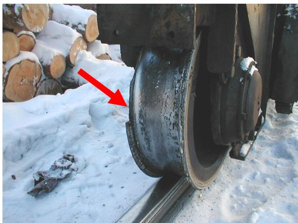
**Рис. 9.** Скол реборды ходового колеса башенного крана в результате значительного износа.
