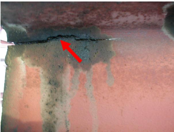
**Рис. 5.** Трещина в раме грузовой каретки козлового крана ККС-10.
