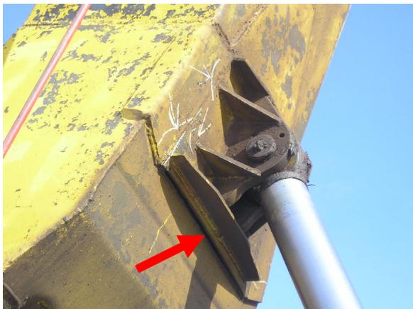
**Рис. 21.** Отрыв кронштейна крепления гидроцилиндра подъема колена подъемника.
