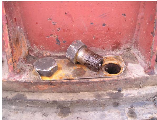
**Рис. 8.** Обрыв болта опорно-поворотного устройства башенного крана.
