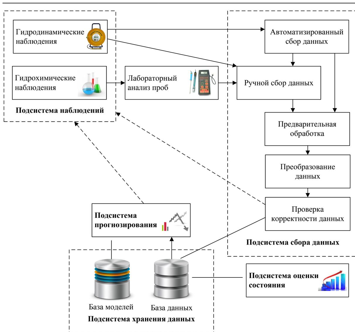
Рис. 1. Структура системы мониторинга состояния подземных вод.
