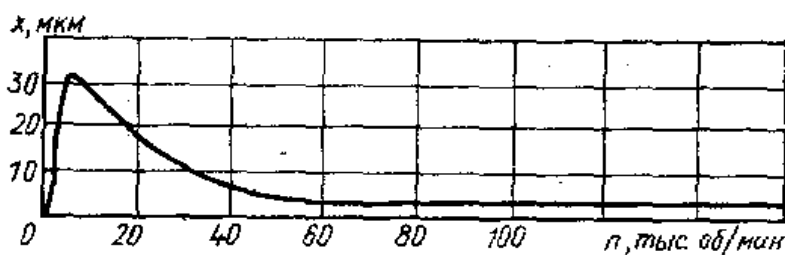
Рис.3. Амплитудно-частотная характеристика цапфы ротора ( x – амплитуда колебаний цапфы относительно положения равновесия)
